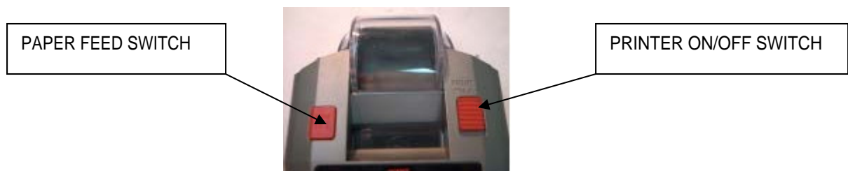
Bild 34 Abdeckung des integrierten Druckers
