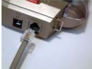
Bild 3 Anschluss des Hub-Kabels am SPORT-EVENT-TIMER
