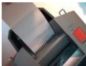
Bild 33 Einführen des Anfangs der Papierrolle in den Führungsschacht
