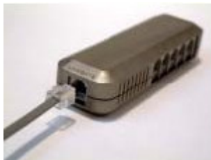
Bild 4 Anschluss des Hub-Kabels an der LINKGATE-Einheit (Hub)
