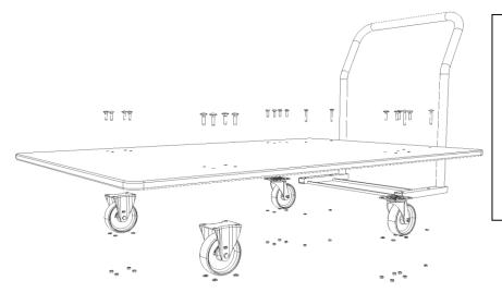
Befestigen Sie sowohl pro Rad jeweils 4 Schrauben, Muttern und Federringe, als auch 4 Schrauben, Muttern und Federringe für den Bügel. In der Abbildung links werden sämtliche Teile zur Übersicht in einer Explosionszeichnung dargestellt.
