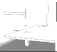
Befestigen Sie die Räder mit Hilfe der mitgelieferten Schrauben M8 x 30, den dazugehörigen Muttern und Federringen. Mit einem leichten Hammerschlag sorgen Sie dafür, dass sich der Vierkantansatz im Holz festsetzt und Sie nun die Mutter festziehen können.
