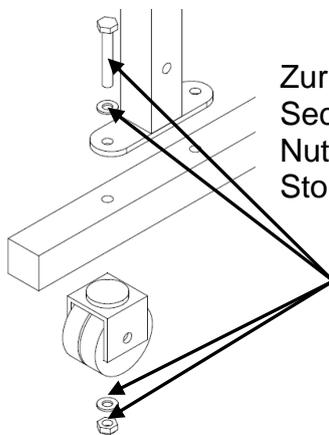
Zur Montage der 4 Doppelschwenkrollen sollten die Sechskantschrauben M 10 x 80 mm verwendet werden. Nutzen Sie dazu ebenfalls 2 x Unterlegscheiben und 1 x Stopmmutter M 10 je Verschraubung.
