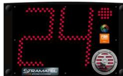
Lautstärke des Hupesignals (115dBa auf 1m): ⚠ Der hohe Schalldruck kann zu Gehörbeschwerden führen. Die Zuschauer müssen in einem angemessenen Abstand von den Anzeigetafeln gehalten werden. Die Lautstärke des Hupesignals kann nicht eingestellt werden.
