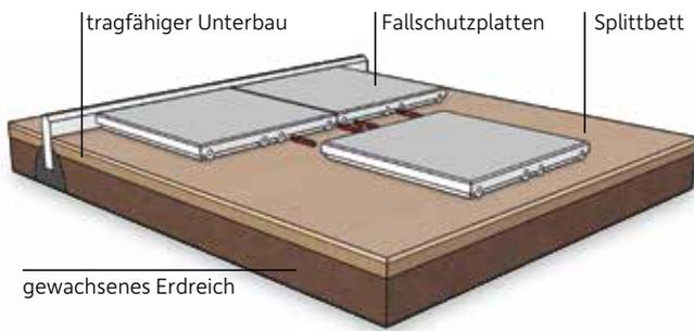
Verlegung (Halbverband) auf sicherfähigem Untergrund (Lava, Basalt, Schotter, Splitt) mit Einfassungselement und Systemsteckern.
