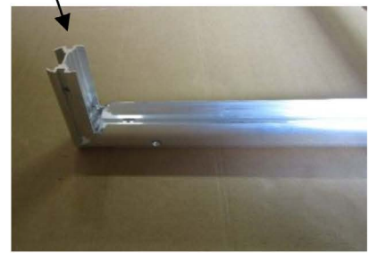
Alu-Eckverbinder in den Pfosten einschieben
