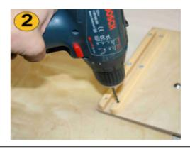
Mit einem 4 mm Bohrer nun die Löcher ganz durchbohren, als Unterlage bitte ein Stück **altes Holz** verwenden. Drill with 4 mm by using a old piece of wood under the part.
