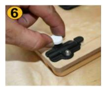
Die Griffmutter aufdrehen aber <u>nicht festziehen</u>. Fix the Handgrid loose on the screw, <u>do not fix tight</u>
