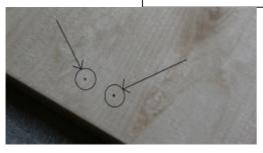
Beim ECKLA Long Trailer muss zusätzlich noch in der Mitte Ein Kunststoffhalter angebracht werden. Bei neueren Versionen sind die Löcher schon leicht angebohrt (siehe links). Bei älteren Versionen müssen die Löcher laut Skizze (unten) noch
