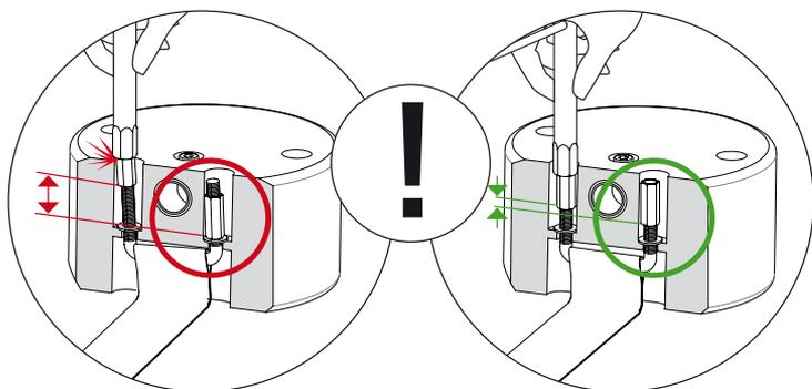
**Achtung!** Durch das Spannen der Slackline neigen sich die Rechteckbügel wechselseitig. Beim Anziehen immer darauf achten, dass der Steckschlüssel noch auf die Langmutter aufgesteckt werden kann.
