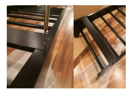
Drehen Sie die Vorderseite der Sprossenwand nach unten. Befestigen Sie die Trageschienen mit acht 6x80 TX25 Schrauben an den Rahmenteilen (dieselben Schrauben, die schon an den Seiten genutzt wurden). Dabei muss die Trageschiene mit dem FITWOOD-Logo am oberen Ende.
