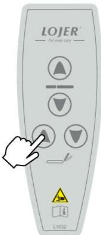
Figura 27. Regolazione dello schienale. Comando manuale.
