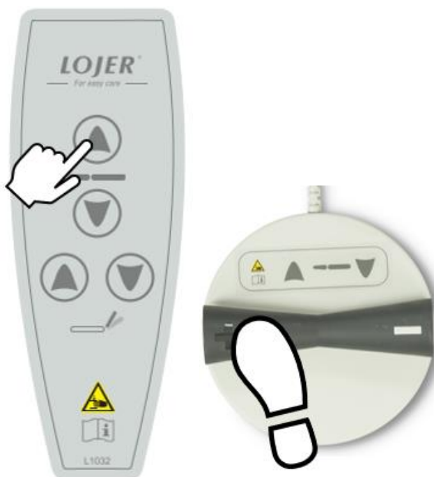
Figura 20. Regolazione dell'altezza. Comando manuale. Comando a pedale.
