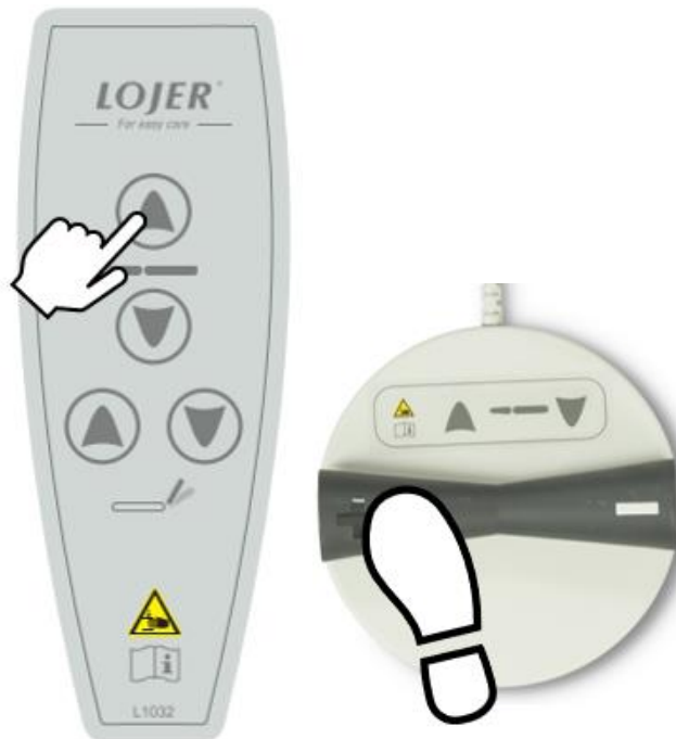
Figur 20. Höhenverstellung. Handsteuergerät. Fußsteuerung.
