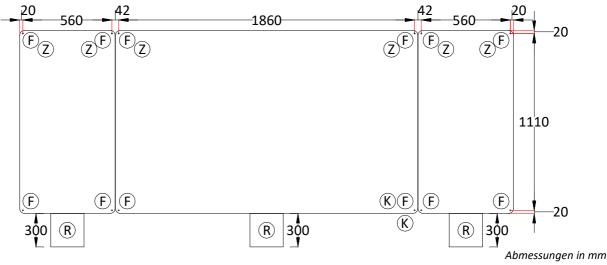
(Z): Befestigungsloch, vorgesehen für die Wartung (Aufbau/Abbau der Frontseite).
