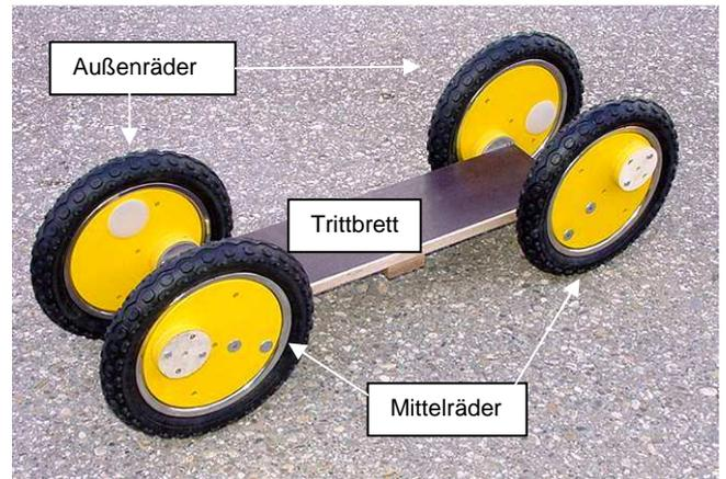
Verschrauben Sie nun zwei weitere Außenräder Mit den Flanschachsen am zweiten Trittbrett.
