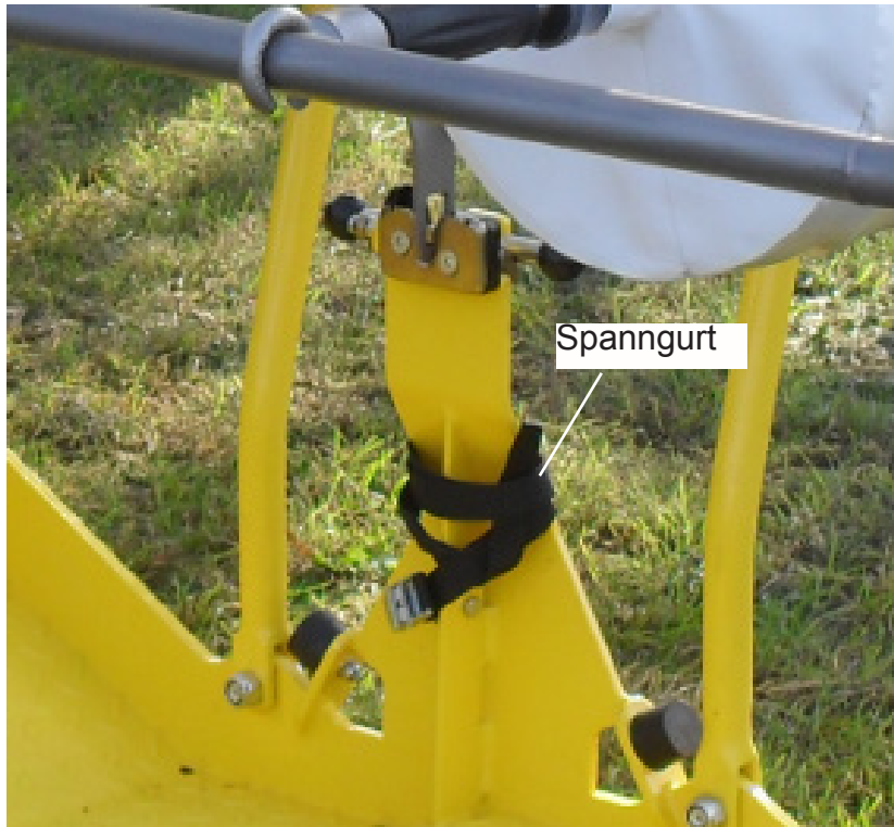
Bild 5-3: Spanngurt zur zusätzlichen Sicherung
