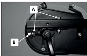
Die Kette muss regelmäßig geschmiert und gespannt werden. Kettenspannung: Schrauben A lösen und mit der Mutter B spannen, so dass die Kette in der Mitte noch 20 mm durchgedrückt werden kann. Anschließend die Schrauben wieder fest anziehen.
