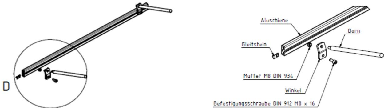
**Abbildung 3:** Befestigung Dorn an Aluschiene
