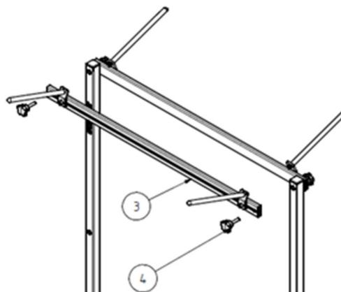
**Abbildung 5:** Montage der Aluschiene an der Aufrechten
