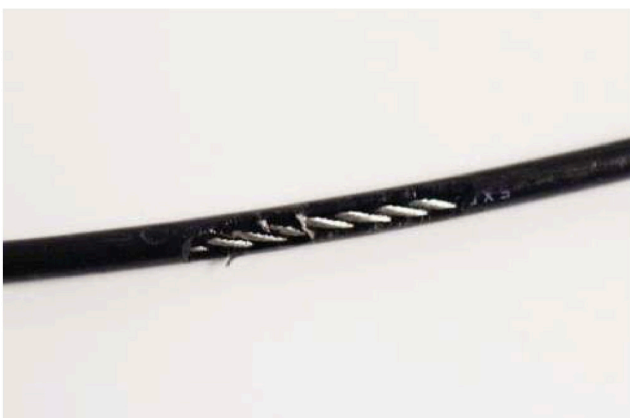
Riss im Kabelmantel
