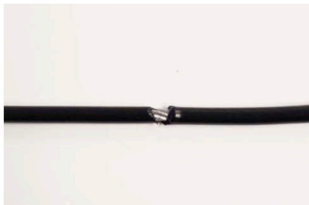
Spalt im Kabelmantel
