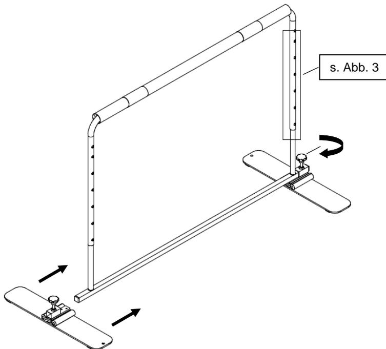
Abbildung 2: Montieren der Standfüße
