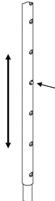
Abbildung 3: Einstellen der Lattenhöhe mit der Rastfeder
