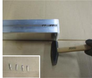
Bodenrohr mit der Nut nach oben hinlegen. In die Nut jeweils am Ende 2 Stck. Einsteckmuttern Länge 20mm, M8 einschieben und das Bodenrohr zwischen den Enden der Bodenholme platzieren. Dann jeweils die Verbindungsplatten (Flachplatten mit 4 Stck. Bohrungen) auflegen und die bereits eingeschobenen Einsteckmuttern in Bodenholmen und Bodenrohr so unter die Verbindungsplatten schieben, dass die Bohrungen deckungsgleich sind.
