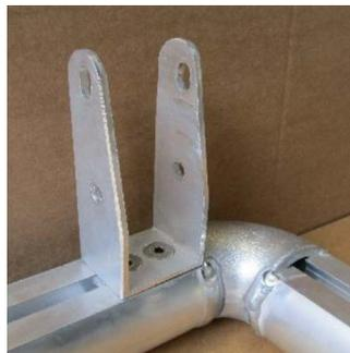
b) In die Nut des Pfostens von unten (Pfostenende) jeweils 2 Stück Einsteckmuttern 20mm, M 8 stecken und ganz nach oben schieben. Oberes Scharnier mit 2 Stück Befestigungsbohrungen ganz oben unter den 90°-Bogen auflegen. Dabei beachten, dass die angeschrägte Seite des Scharniers zur Torinnenseite zeigen muss. Einsteckmuttern 20mm, M 8 unter die Bohrungen im Scharnier schieben und Scharnier mit Sicherungs-Senkschrauben DIN 7991, M 8 x 16 befestigen und Schrauben fest anziehen.
