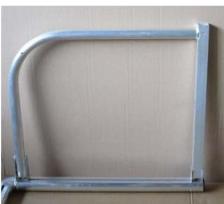
e) Netzbügel in die Scharniere einfügen. Dabei darauf achten, dass das Ende des Netzbügels mit 2 Bohrungen (Rundrohr) in das obere Scharnier und das Ende mit 1 Bohrung (Quadratrohr) in das untere Scharnier gesteckt wird. Den Bügel so in die Scharniere stecken, dass die Bohrungen jeweils deckungsgleich mit den Bohrungen in den Scharnieren sind.
