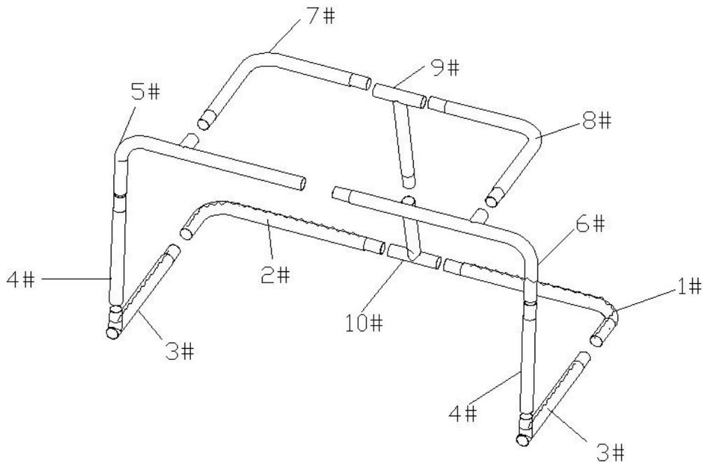
1. Montieren Sie zuerst Stahlrohr #1, #2, #10.
