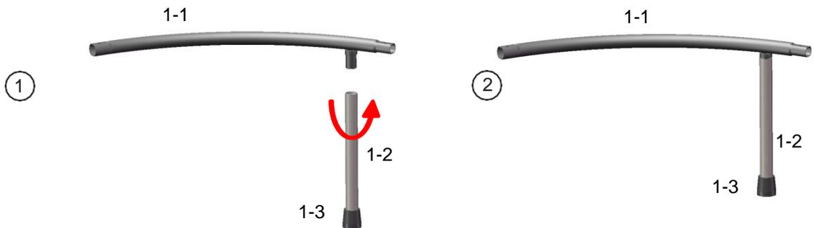
Schrauben Sie den Fuß (1-2 in das Rahmenteil (1-1) an. Achten Sie dabei darauf, dass die Verbindung fest angedreht ist.
