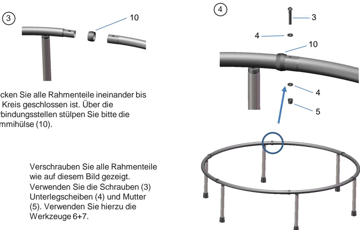
Stecken Sie alle Rahmenteile ineinander bis der Kreis geschlossen ist. Über die Verbindungsstellen stülpen Sie bitte die Gummihülse (10).
