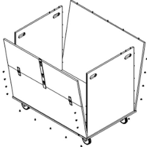
Abbildung 4: Montage Vorder- und Rückwand
