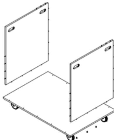
**Abbildung 3:** Montage Seitenwände
