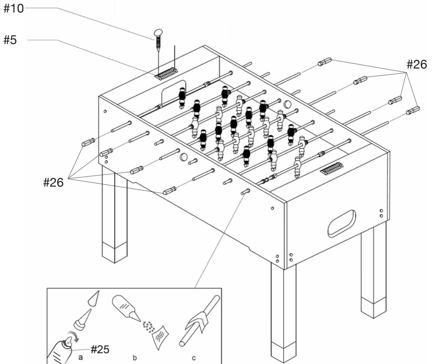
**Gebe das Schmiermittel in ein trockenes weiches Tuch und trage das Schmiermittel leicht auf die Fläche an Kickerstangen auf an denen diese mit den Stangenlagern in Verbindung kommen.**
