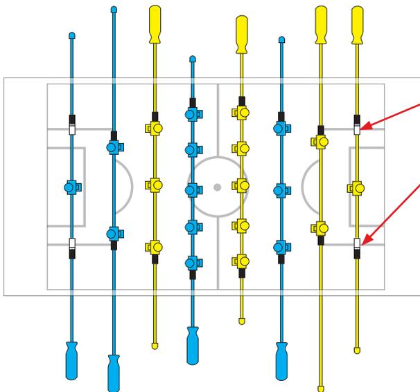
**Diesen Stellring nur an die Torwart-Stange montieren (2x)**
