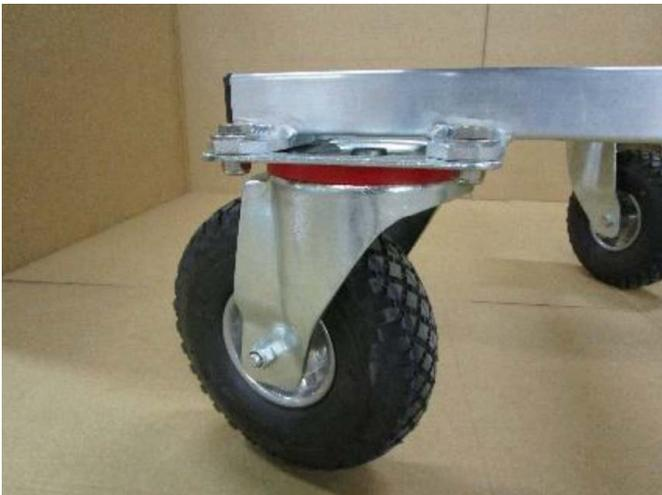
Die vorbereiteten Schrauben von der Oberseite durch die Bohrung der Alu-Platten und der Lenkrolle stecken (siehe Foto unten links). Von der Unterseite 4 Stck. selbstsichernde Muttern M10, DIN 985 aufschrauben und fest anziehen (siehe Foto unten rechts).
