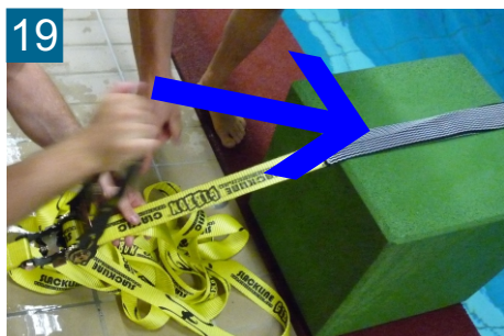
19 Veiller à placer la protection anti-abrasion de façon uniforme
