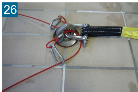
26 De l'autre côté, fixer la corde de sécurité à la manille
