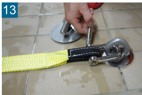
13 Attacher la vis de fixation avec la slackline à l'aide de la manille
