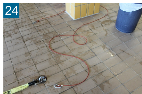
24 Passer la corde de sécurité autour d'un élément de retenue
