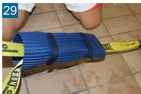
29 Fixer la protection du cliquet avec des bandes auto-agrippantes
