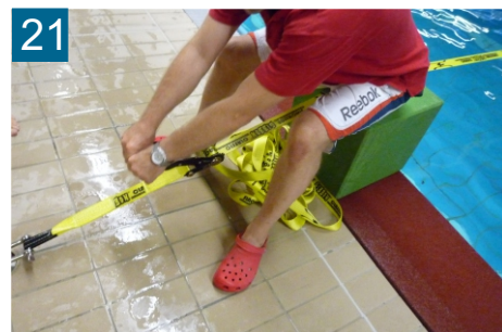
21 Tendre la slackline à la force des bras Important: sécuriser le cliquet
