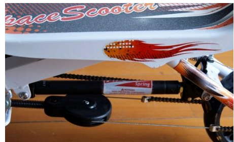
Antriebsmechanismus mit Luftdruckdämpfer
