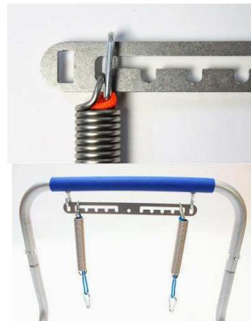
4. Dann beide Aufhängeleisten mit den Federn an den Haken im Rohrgestell einhängen. Alle Sicherheitsleinen nach unten straffziehen.
