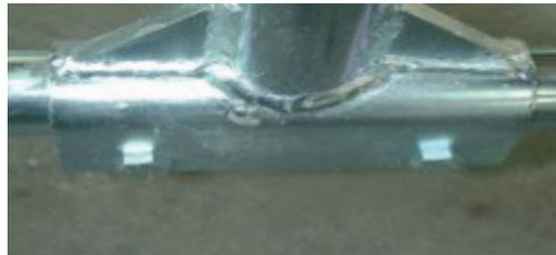
Befestigung des Tragebügels genau in der Mitte des Grundrahmens mit Hilfe der Schrauben 8x 50 + Mutter (Bitte beachten, dass der Tragebügel nicht auf der Schweißnaht des Rahmens verschraubt werden kann).
