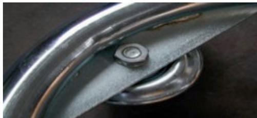
Verschraubung der ungebremsten und gebremsten Rollen am Rahmen, wobei das am Rahmen angebrachte Flacheisen nach unten zeigt. Gebremste Rollen sollten nicht an der Seite der Schweißnaht des Grundrahmens bzw. der gegenüberliegenden Seite angebracht werden.
