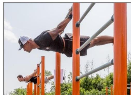
Die Klimmzugstange ist in einer Höhe von 233 cm montiert, mit einem uneingeschränkten Übungsbereich darunter, neben einer vertikalen Leiter mit 6 horizontalen Stangen. Der Abstand zwischen den Stangen beträgt 38 cm.
