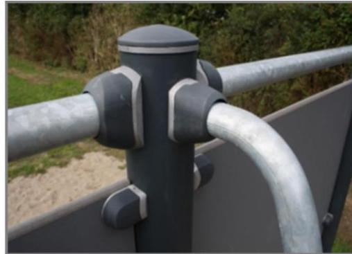
Die Verbinder sind aus druckgegossenem Aluminium hergestellt, das speziell für den Außenbereich und starke Beanspruchung legiert ist. Die Schrauben zur Befestigung der Verbinder sind aus Edelstahl und durch Zink-Unterlegscheiben geschützt.
