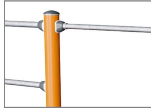
Alle Stangen, die für Klimmzüge vorgesehen sind, bestehen aus massiven, feuerverzinkten Stahlstangen (S235JR) mit einem Durchmesser von 32 mm x 138 m. Dieser Durchmesser bietet für jeden den richtigen Halt.
