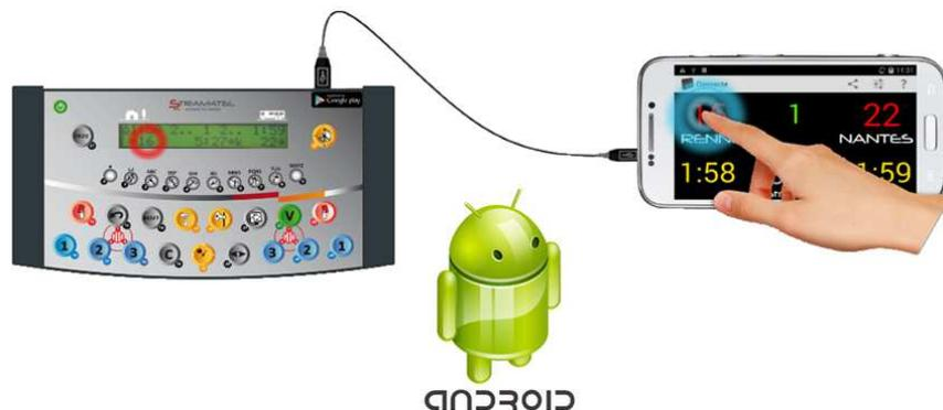
Das Smartphone/Tablet wird an den USB-Anschluss des Bedienpultes angeschlossen und die Hauptfunktionen der Anzeigetafel (Punkte, Spielzeit, Strafen, Mannschaftsnamen, Fließtext, ...) können so gesteuert werden.
